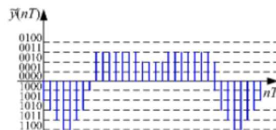
Рис. 1.5. График цифрового сигнала на выходе системы ЦОС (вычислителя)
